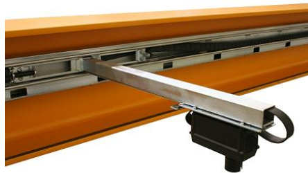
Chariot de la boîte à boutons de la commande mobile sur la chenille porte-câble
