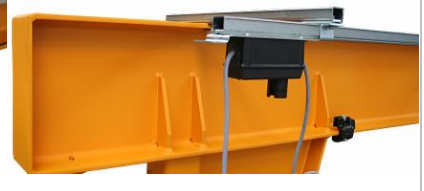
Commande fixe sur la potence (commande de secours)
